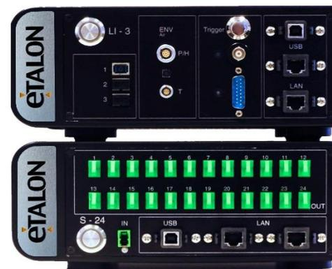
Interferometer LI-3 und Switch S-24
