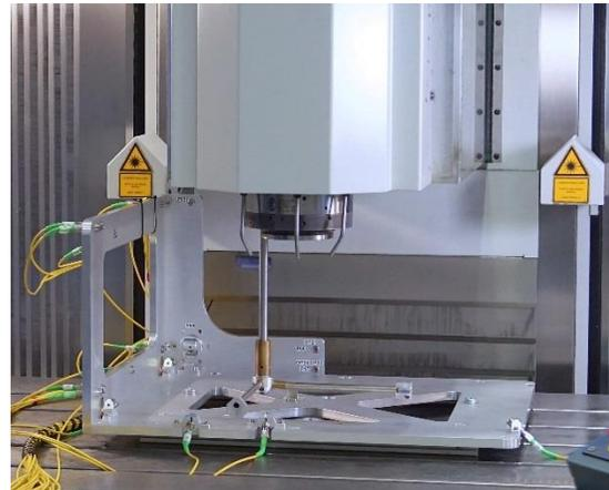
Vorrichtung mit Messstrahlen auf einer WZM
